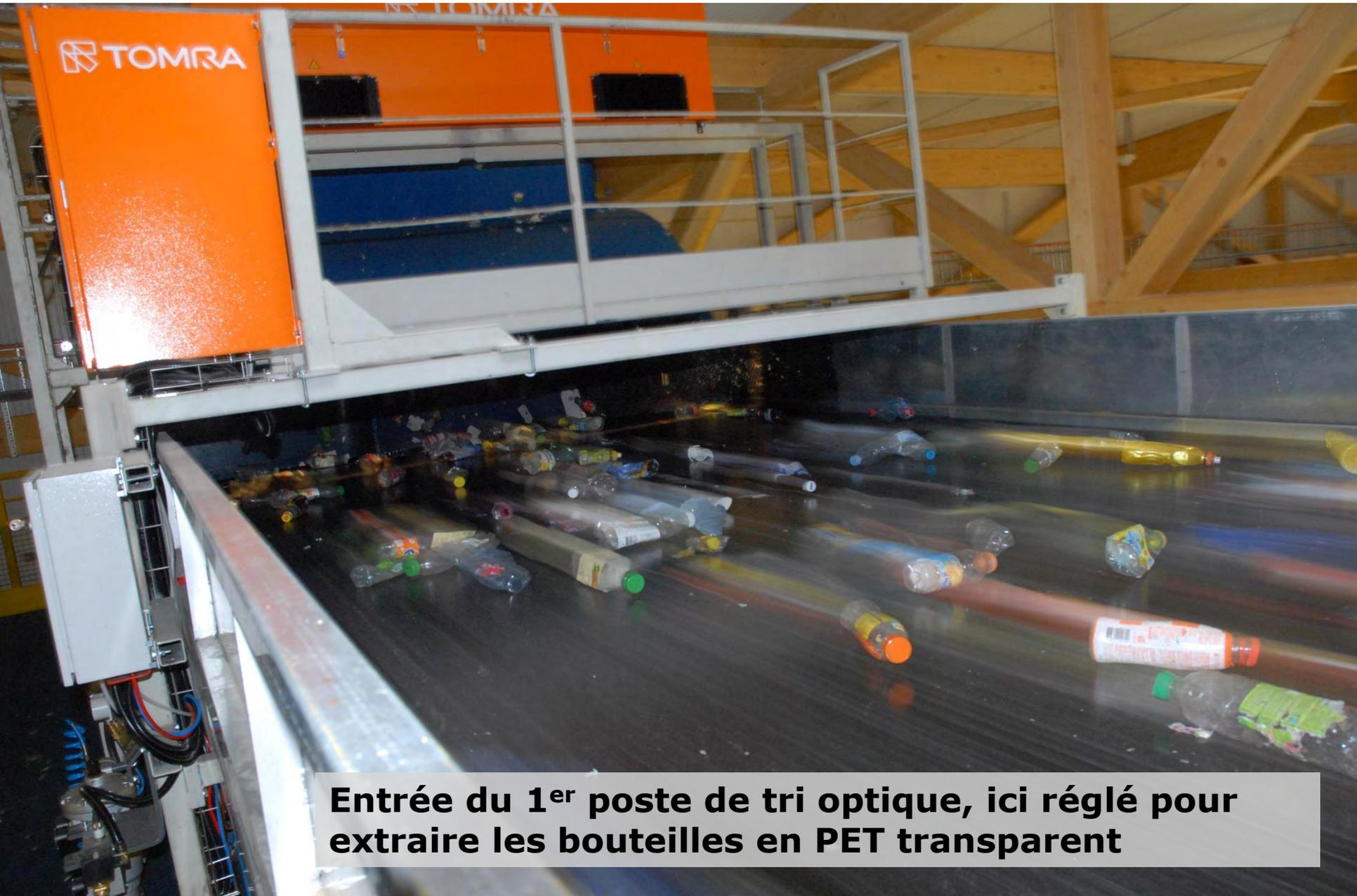
**Entrée du 1<sup>er</sup> poste de tri optique, ici réglé pour extraire les bouteilles en PET transparent**
