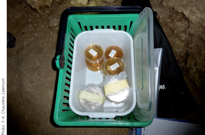
Fig. 4. Intervention de Viteos à Cotencher, août 2014. Aspiration de volumes d'air donnés (50, 100, 250, 500 et 1000 litres) sur des boîtes de Pétri avec une gélose contenant un milieu de culture approprié.
