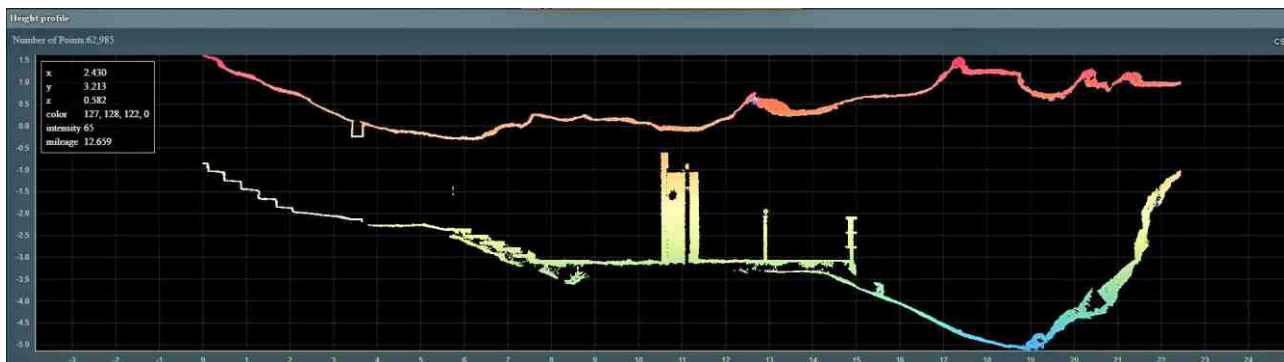
Figure 30. Les données du nuage de points peuvent être utilisées pour générer des coupes à l'aide d'un simple navigateur internet ou d'outils CAD/BIM plus spécialisés (@ archeodev.ch)
