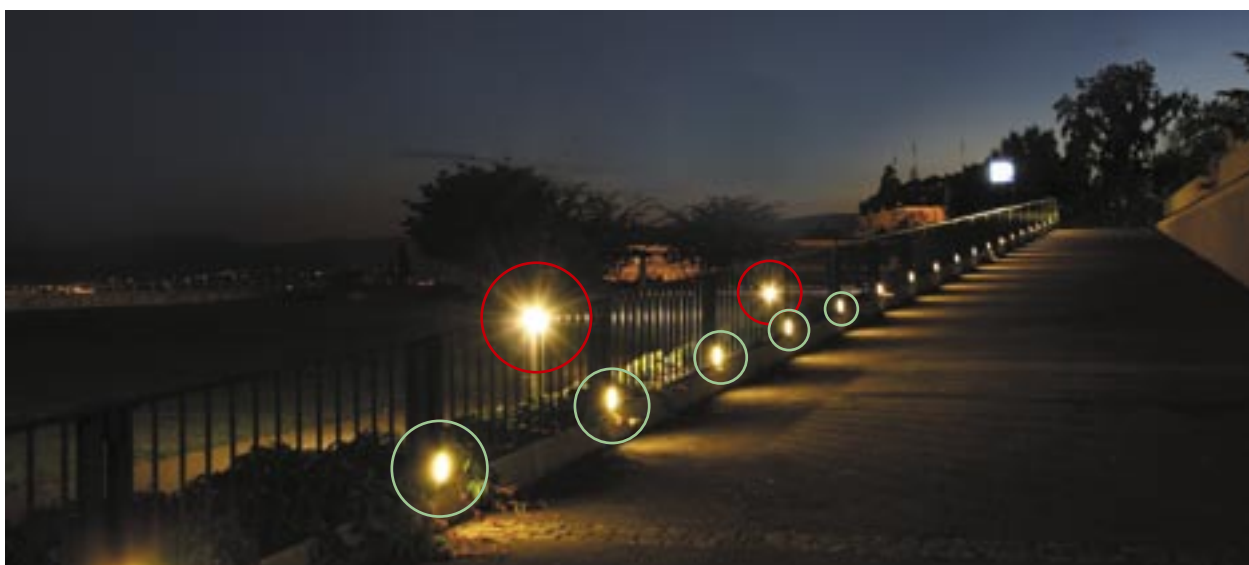
Souvent les bons (○) et les mauvais (○) exemples d'éclairage extérieur se côtoient; un assainissement serait rapide et peu coûteux.
