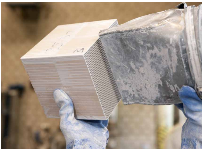
Production de nids d'abeilles en céramique comme support filtrant de filtres à particules performants. Dans le domaine de l'épuration des gaz d'échappement des moteurs diesel, les entreprises suisses font figure de pionnières.
