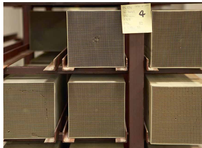
Ces modules en céramique sont prêts pour le montage dans de grands filtres à particules. Les particules de suies de diesel sont retenues à l'intérieur des nids d'abeilles en céramique et sont périodiquement calcinées.
