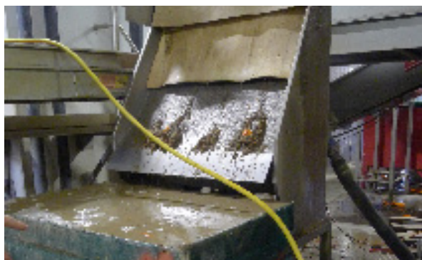
Figure 39: photo: tbfpartner Tamis incurvé pour l'élimination des matières solides après le parage des carottes.
