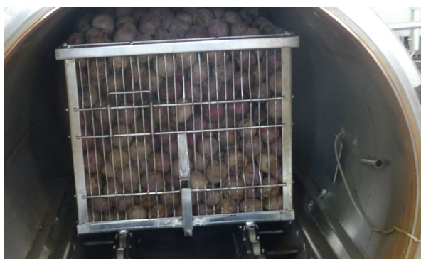
Figure 14: À gauche: cuisson en contact direct avec de la vapeur (betteraves rouges). À droite: cuisson dans l’emballage sans contact direct entre la vapeur et le produit (pommes de terre).
