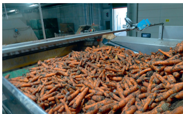
Figure 8 : Convoyeur vibrant pour retirer la terre.
