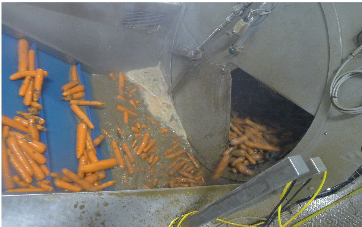
Figure 9: Le produit brut (carottes) est simultanément lavé et paré dans un tambour rotatif. Les frottements permettent d'obtenir une surface propre et lisse.
