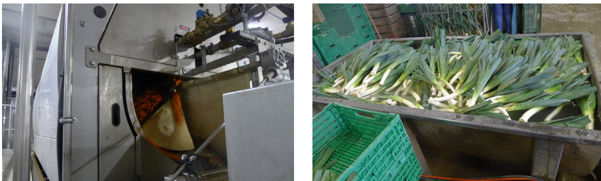
Figure 10: Lavage mécanique (carottes dans un tambour de lavage) et lavage manuel (poireaux).
