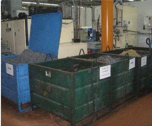
Stockage des limailles métalliques à l'abri des intempéries, sur un sol étanche et sans écoulement
