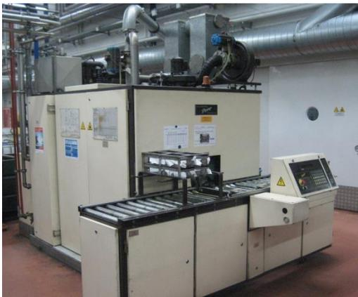
Installation de nettoyage aux hydrocarbures halogénés répondant aux exigences légales (ch. 87 de l'OPair)
