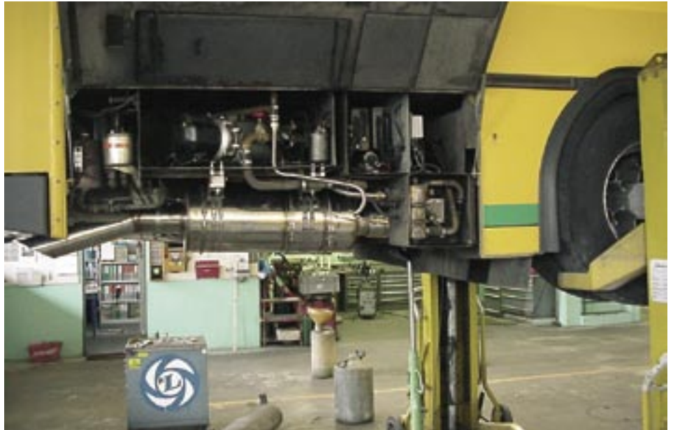
Pose d'un filtre à particules sur un bus diesel. En Suisse, les entreprises de transports publics ont déjà doté des centaines de véhicules de ce système de dépollution très performant.
