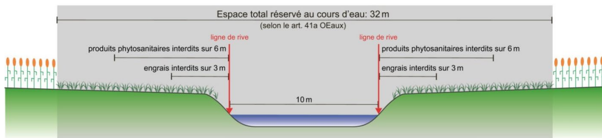
Figure 34 : Méthode de mesure selon les dispositions ORRChim/OPD après détermination de l'ECE (LN>2.0 m)
