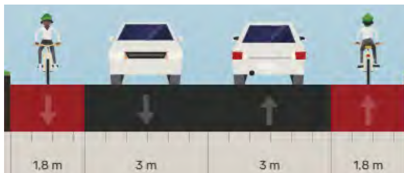
Figure 13 – Coupe type des bandes cyclables au standard normal
