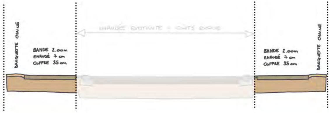
Figure 27 - Profil type pour des pistes cyclables unidirectionnelles hors localité
