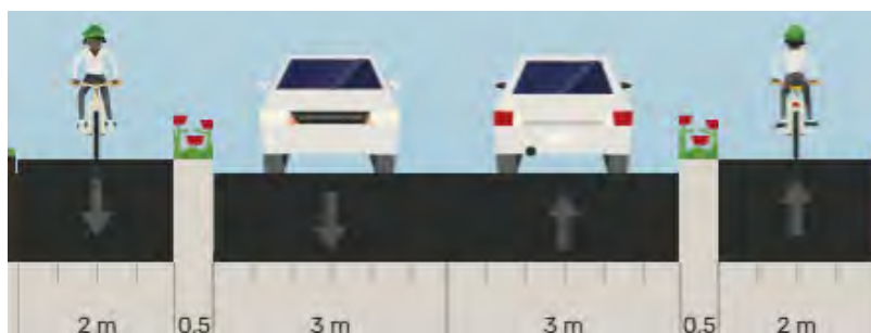
Figure 12 – Coupe type des pistes cyclables unidirectionnelles au standard normal
