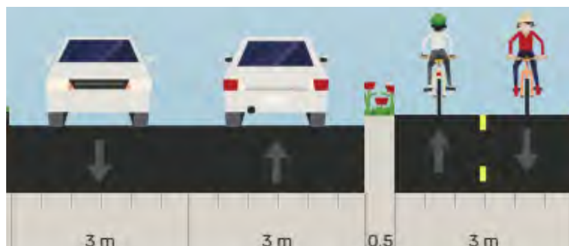
Figure 11 - Coupe type d'une piste cyclable bidirectionnelle au standard normal
