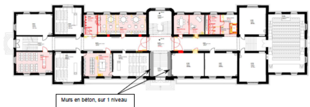
Fig. 3 - Rez-de-chaussée : 2 Murs en béton à ajouter
