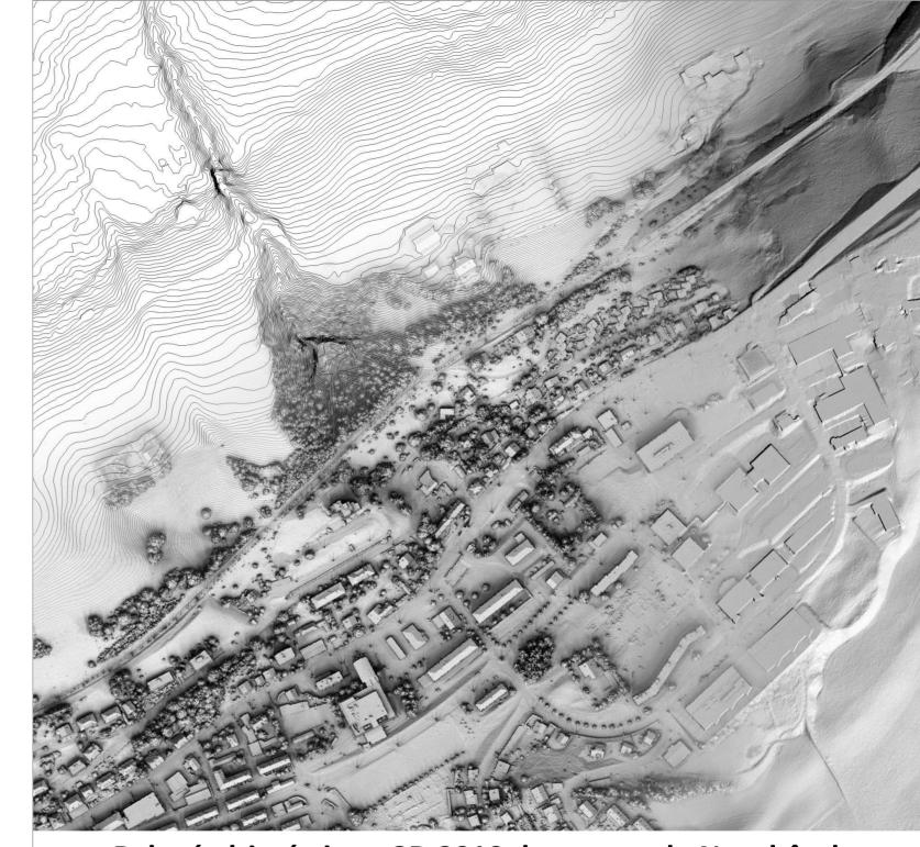
Relevé altimétrique 3D 2010 du canton de Neuchâtel basé sur la technologie de balayage laser aéroporté
