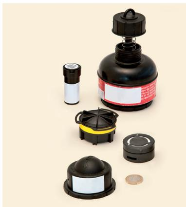
Appareils de mesure de la concentration en radon
