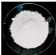
b) A gauche, enrochements de taille métrique; c) à droite, farine de roche de taille <math><0.06\text{ mm}</math> pour la fabrication de ciment.
