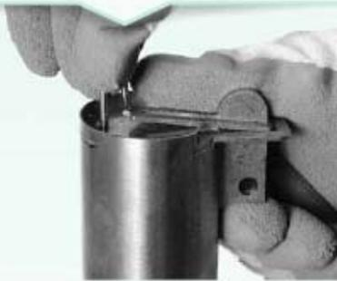
Rabattez le clapet vers la tige des déclencheurs et fixez-le à plat sur le couvercle avec le pouce. De l'autre main, levez la tige des déclencheurs jusqu'à l'arrêt.
