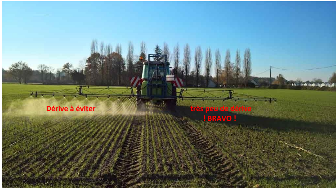
Photo : rampe à gauche avec des buses non adaptées ; à droite avec des buses anti-dérive bien réglées.
