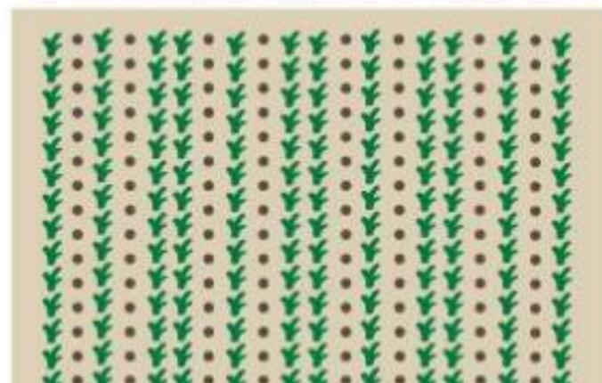
Semoir à 24 rangs, 12,5 cm d'espacement entre les rangs. 10 rangs (40%) non semé
