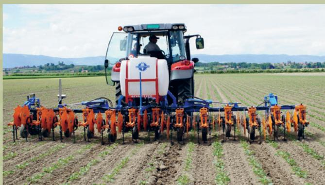
*Les nouvelles sarcleuses peuvent être conduites par une seule personne grâce au système de guidage par satellite (GPS) et par caméra; Cela permet d'obtenir un rendement élevé/ha puisque le travail réalisé est de haute précision.*
