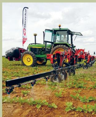
*Grâce au traitement en bandes, l'application est limitée sur la ligne, ce qui permet de réduire l'usage d'herbicides.*
