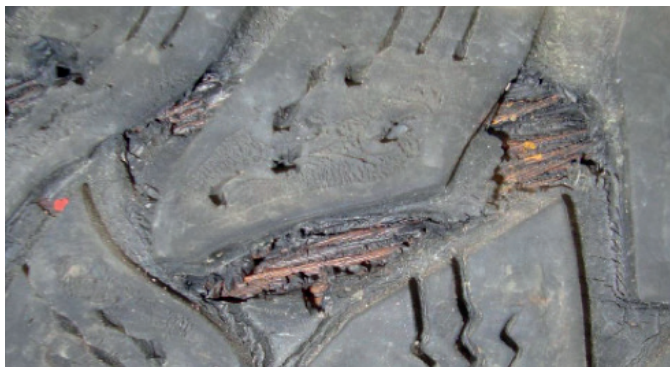
Ceinture d'acier et bandage visibles.
