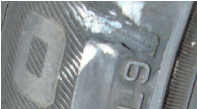
Petites éraflures, les fils d'acier et le bandage ne sont pas visibles.
