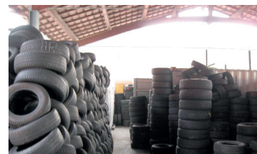
Les dépôts de pneus doivent toujours être équipés d'un sol en dur (revêtement étanche) et couverts dans la mesure du possible.
