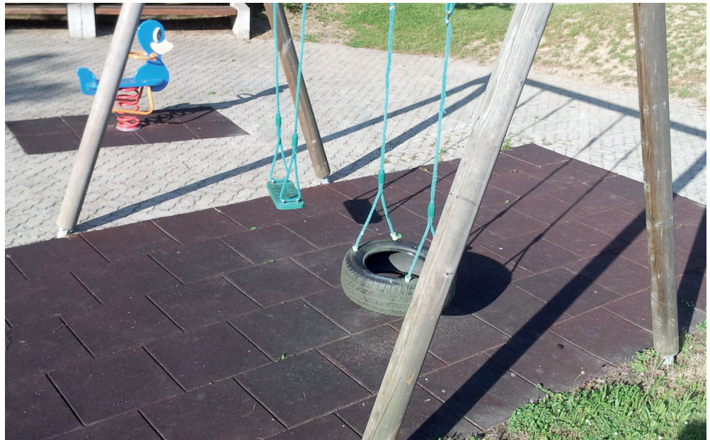
Tapis de protection contre les chutes en granulats de pneus.
