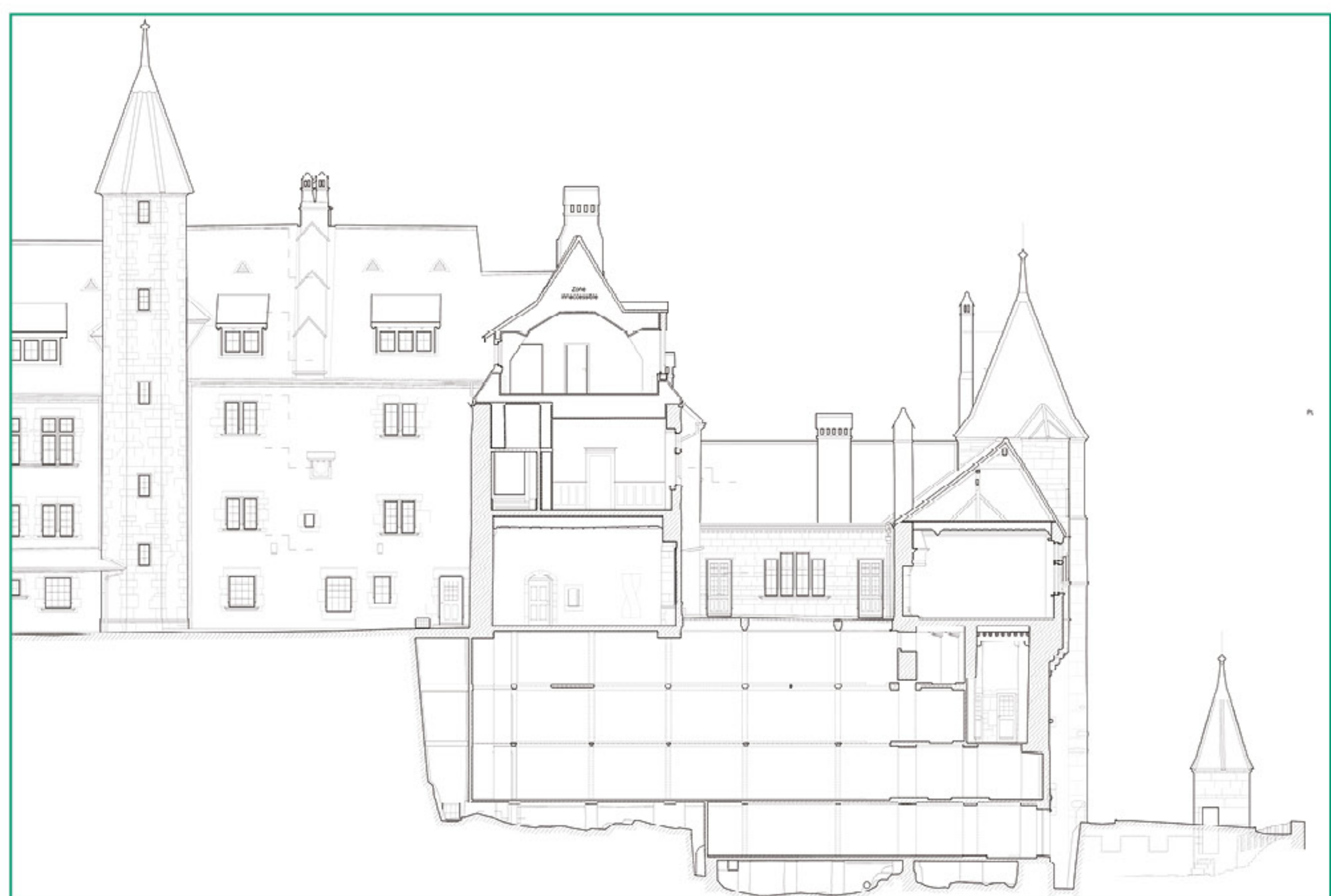
Vers 1913, l'excavation et les reprises en sous-œuvre nécessaires à l'installation de quatre niveaux de dépôts d'archives constituent un gigantesque chantier. (OAEN, coupe du château, relevé récent par le SBAT)
